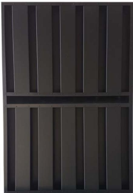
Eliminador ou Separador de Areia, "SAND TRAP", modelo SSL, é utilizado em tomadas de ar externo em regiões sujeitas à ventos carregados de areia. Sua função é proteger ambientes e máquinas do excesso de areia que exista no exterior. É utilizado em sistemas de geração de energia e sistemas de ar condicionado ou trocadores térmicos, instalados em zonas desérticas ou nas proximidades de dunas e praias onde seja normal o arraste de areia pelo vento.
