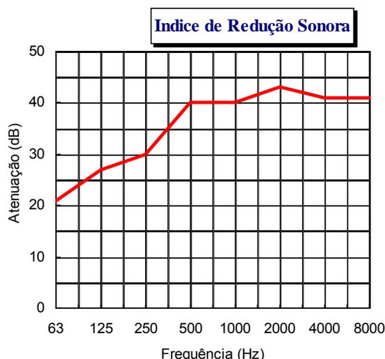
**Nota1:** A porta 46dB pode ser utilizada como porta hermética, na construção com soleira saliente, sendo apta a uso em casas de máquinas ou plenos de ar condicionado, resistindo a diferença de pressão positivas ou negativa de até 80 mmca.
